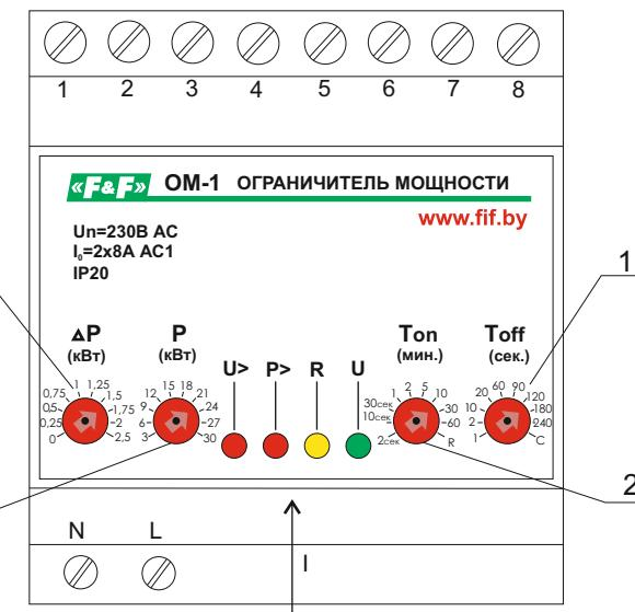
Рис.8 Органы управления и индикации
